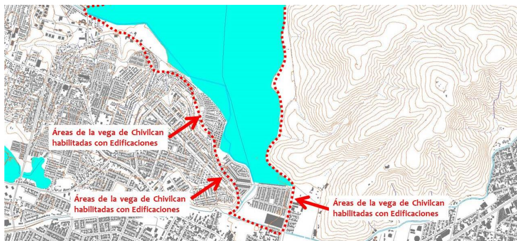
Fotografía N° 27. La línea roja punteada muestra el límite natural de la llanura aluvial y con flechas se muestra las edificaciones emplazadas dentro de esta unidad geomorfológica.
