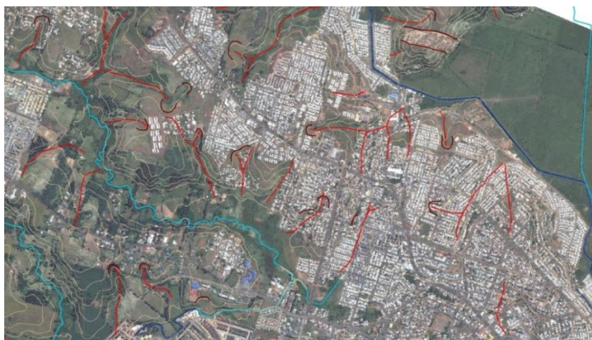
Figura N°80. Red de Drenaje Sector Pedro de Valdivia con Conformación de cabeceras de Erosión.
