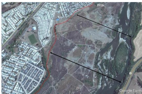
Fotografía N° 42 y 43. Imagen Google Earth del año 2013 y 2015, la línea roja marca el límite de la llanura de inundación (con flechas negras se identifica el ancho) y hacia el cauce los depósitos de aluviones en distinto grado de sedimentación. En la imagen del año 2013 se aprecian extracciones de áridos.
