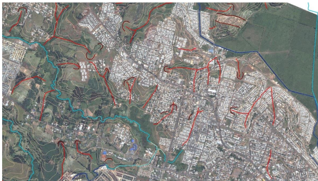
Figura N° 23. Red de Drenaje Sector Pedro de Valdivia con Conformación de cabeceras de Erosión.
