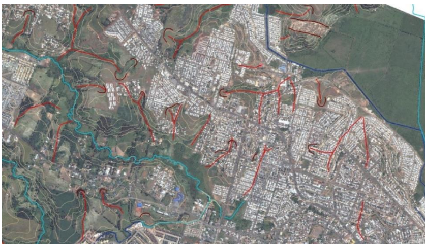
Figura N°71. Red de Drenaje Sector Pedro de Valdivia con Conformación de cabeceras de Erosión. Fuente: Elaborada Equipo Consultor sobre la Base de las Curvas de Nivel Entregadas por el Municipio de Temuco.
